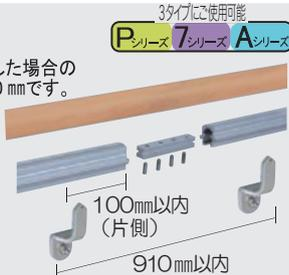
\*ストレートジョイントの取付けは、必ず左右のレールに2箇所ずつビスで固定してください。
